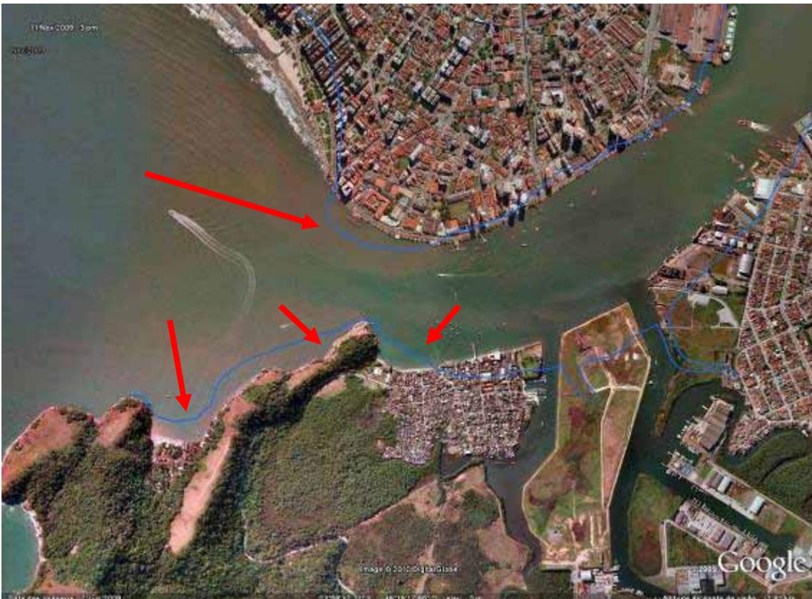
**Figura 32:** Locais de erosão da barra.
