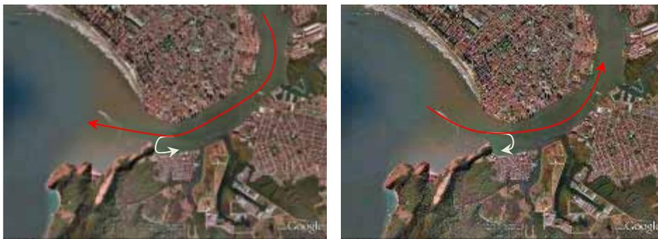
**Figura 29** - Área de baixa energia hidrodinâmica à montante da fortaleza. Deposição na enchente e na vazante.
